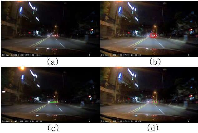
그림 2. 차량 인식 결과, (a)저조도 개선 전 차량 인식 결과 (b) 저조도 개선 후 차량 인식 결과 (c) 후미등 검출 결과 (d) 후미등 검출 및 저조도 개선 후 차량 인식 결과
